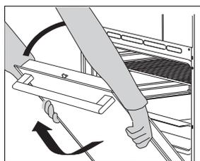
**3** Pomalu zavírejte dvířka, dokud západky pantů nebudou zarovnané s drážkami. Mírně zvedněte dvířka a vytáhněte je z obou závěsných otvorů na spotřebiči. K nasazení dveří, opakujte postup v opačném pořadí. Pokud se dveře neotvírají nebo nezavírají, ujistěte se, že zářezy na závěsech jsou zarovnané s lůžky závěsů.
