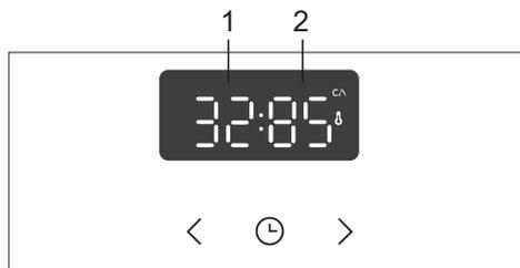
**3** Otočte VOLIČEM SYSTÉMU VAŘENÍ (horký vzduch a dolní topné těleso). Symbol, nastavená teplota, aktuální teplota a požadovaná teplota se objeví na displeji. V případě, že je teplota teplotní sondy nižší než 30 °C, objeví se na displeji "-: 80". Stiskněte tlačítko START.
