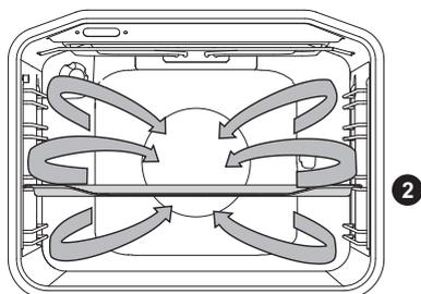
Pracují kruhový topný článek a ventilátor. Ventilátor nainstalovaný v zadní stěně uvnitř trouby zajistí konstantní cirkulaci horkého vzduchu kolem pečeně nebo pečiva.
