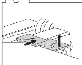
**1** Mírně nadzvedněte držáky na levé straně dveří (označení 1 na držáku) a vytáhněte je směrem od skleněné tabule (označení 2 na držáku).
