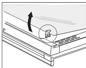
**3** Chcete-li odstranit třetí skleněnou tabuli (pouze u některých modelů), nadzvedněte ji a odstraňte. Také odstraňte gumové těsnění na skleněné tabuli.
