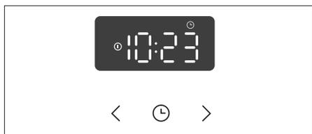
**1** Stisknutím tlačítek < nebo > nastavíte čas. Nejdříve nastavte minuty. Potvrďte nastavení stisknutím tlačítka ⌚. Poté nastavte hodiny. Po třech sekundách se nastavení uloží.
