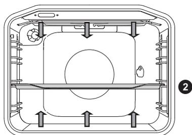
Topné články ve spodní části a ve stropě uvnitř trouby budou rovnoměrně vyzařovat teplo do vnitřku trouby.
